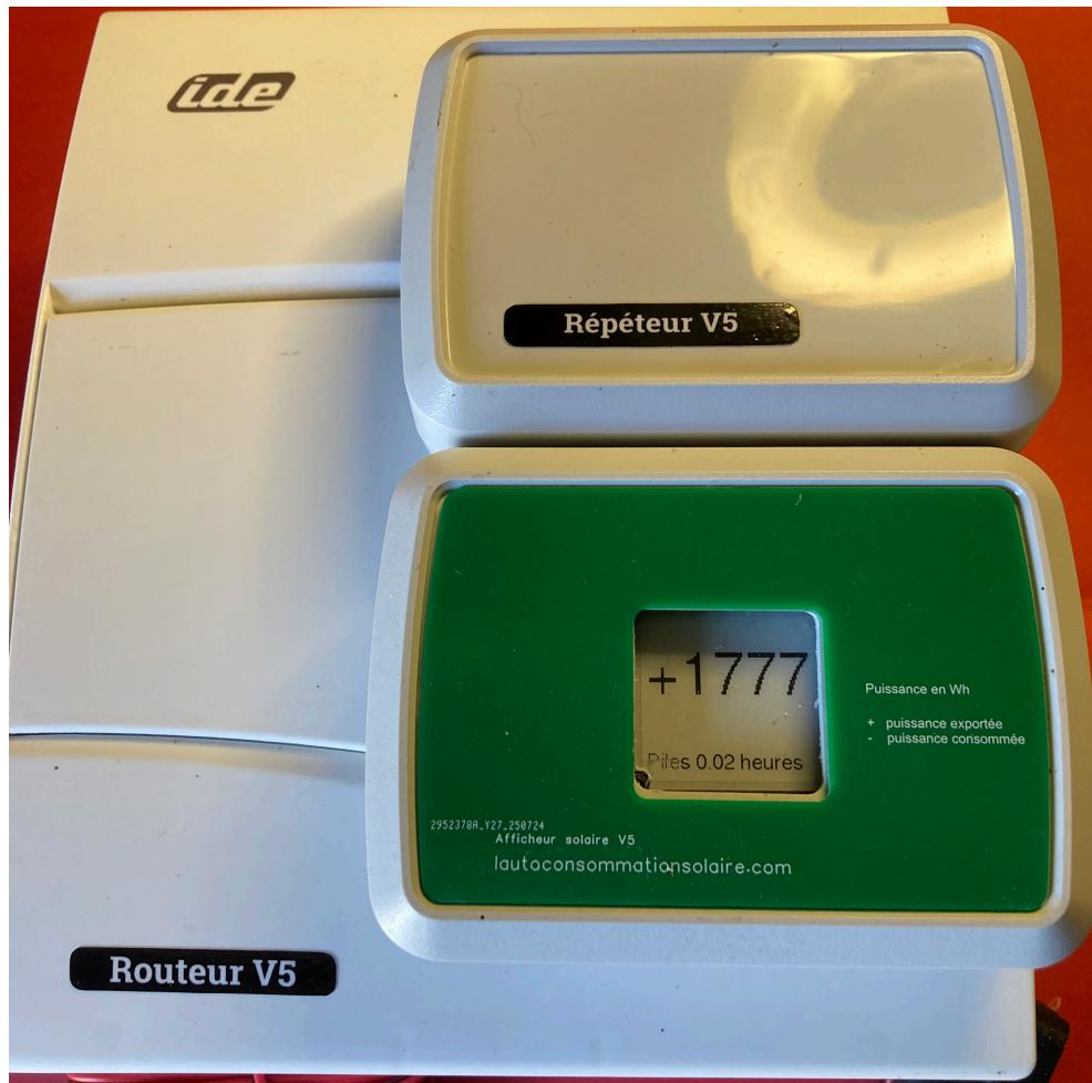
Le kit de test se compose d'un routeur solaire , d'un afficheur solaire et un répéteur .
